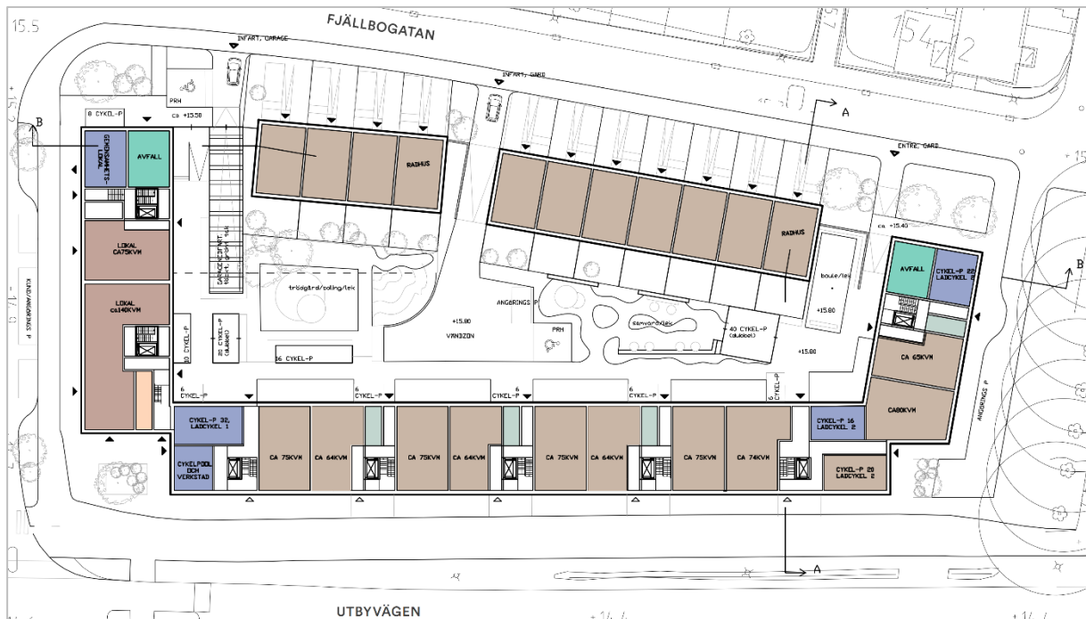
Figur 26 Översikt över parkeringslösningar för bil och cykel i markplan. Det finns 2 parkeringar för rörelsehindrade, 1 angöringsparkering, 11 parkeringar till radhusen samt 178 cykelplatser till flerbostadshuset och 22 cykelplatser till radhusen. (Okidoki, 2023-03-08)
